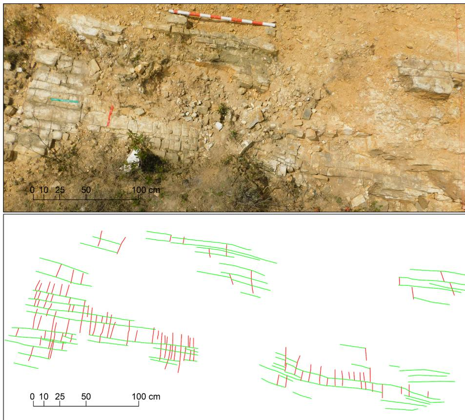
Figura 26. Fotografía y esquema de interpretación de fracturas bajo la metodología de ventana de muestreo para la Fm. Plaeners. Elaboración propia.
